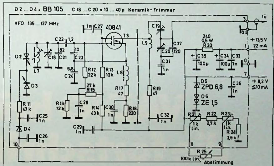
halb wurde der mit Z-Dioden bestückte und temperaturkompensierte Stabilisator vorgesehen. Er arbeitet mit D5 und D6, deren Temperaturgänge sich gegenseitig aufheben. Die Ausgangsspannung von 8,2V ist auch beim Betrieb im Freien mit starken Schwankungen der Umgebungstemperatur hinreichend stabil. Der Wert des Dioden-Vorwiderstandes R20 ist allein zutreffend für die Empfänger-Gesamtschaltung, wird nur das HF-Teil als Konverter verwendet, muß er auf 470  $\Omega$  (0,5 W) vergrößert werden.
