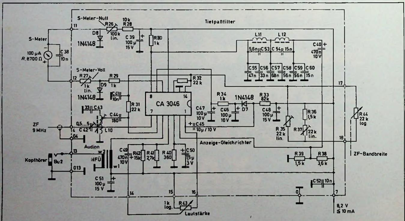
Für den Übertrager NF-Ü kommt eine Ausführung für 1 mA Gleichstrom-Dauerlast der Primär-Wicklung in Frage, die Impedanzwerte können ohne Nachteil um 50% streuen.
