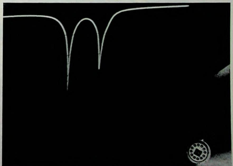
wendung von Gyrotoren hergestellt und mit PN-Übergängen als Kapazitäten zu Schwingkreisen kombiniert. Es gelang, Resonatoren mit Q-Faktoren bis 30 und Fallen mit Unterdrückungsfaktoren über 40 dB zu verwirklichen. Das Bild zeigt einen Resonator für 4,43 und 6 MHz neben seiner Sperrfilter-Kennlinie. Der 1 mm<sup>2</sup> große Chip umfaßt außer dem Resonator noch 15 Transistoren.
