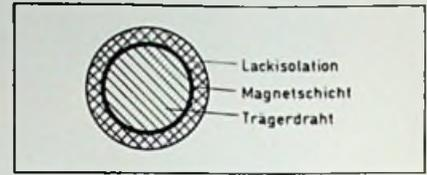
Bild 3. Der Aufbau des Magnetschichtdrahtes im Querschnitt.
