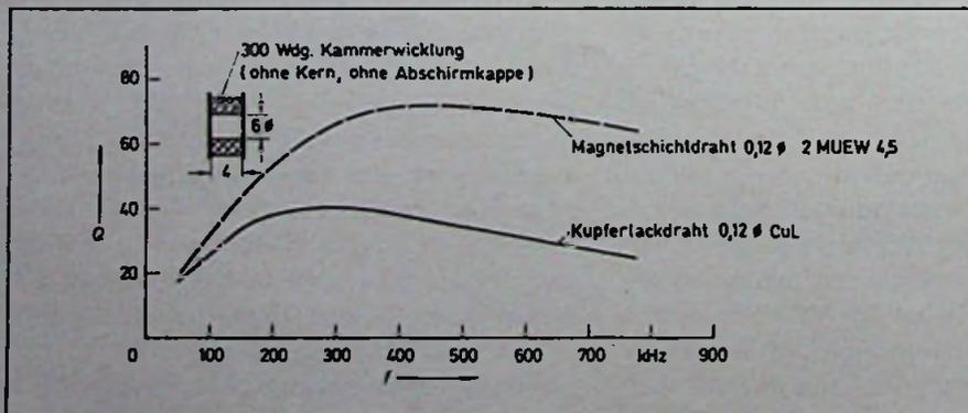
und kleiner Wickelraumbedarf. Der kleine Wickelraumbedarf des Magnetschichtdrahtes ermöglicht den Aufbau räumlich kleiner Spulen. Diese Eigenschaft kommt der Tendenz nach Miniaturisierung der Bauelemente entgegen.
